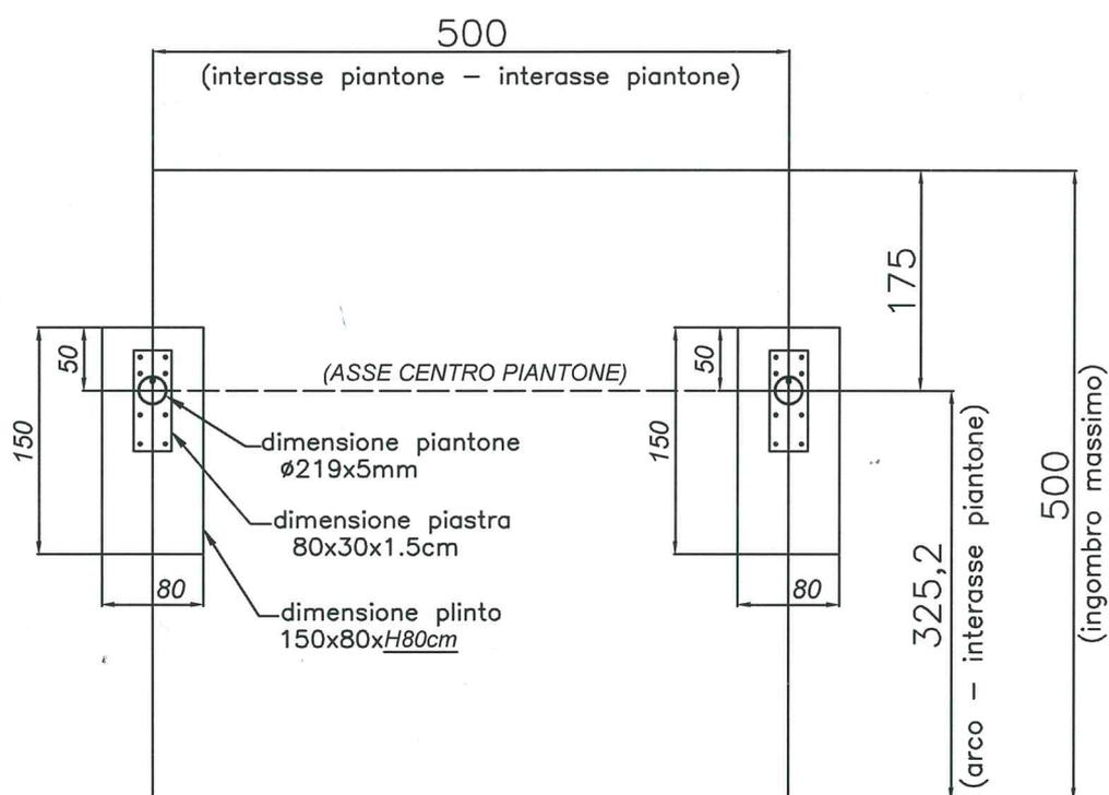
**PRESCRIZIONI PER L'ANCORAGGIO DELLA STRUTTURA MOD. CONDOR A SBALZO 5,00m x 5,00m** (ipotesi di utilizzo temporaneo della struttura, e quindi con azioni esterne di neve e vento a valori ridotti secondo la Norma UNI-EN 13782:2015 - vento ~28 m/s (~100 Km/h) - neve 20daN/mq
